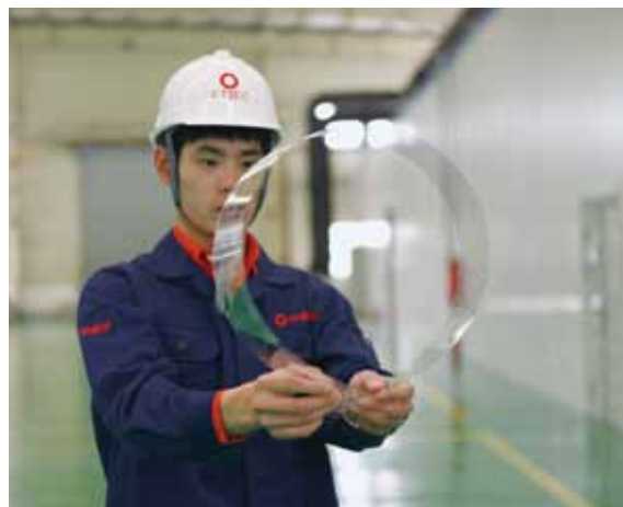
国内最薄0.2毫米超薄玻璃
